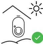
El Wattpilot es adecuado para el funcionamiento en zonas exteriores sin luz solar directa.
