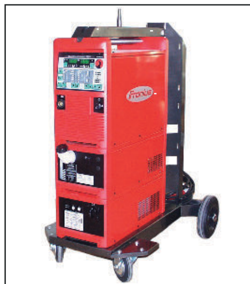
Fahrwagen mit Autotrafo, Kühlgerät und Stromquelle
